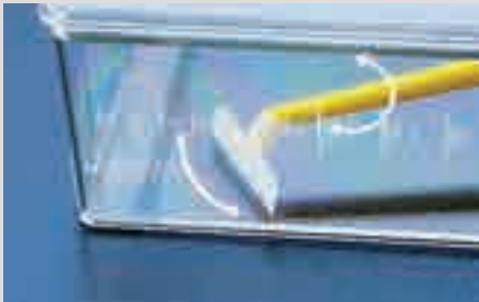
わずかな力でブレードが回転します。ヘッドは一定角で止まるのでフラスコの角などからの細胞の回収が容易です。
