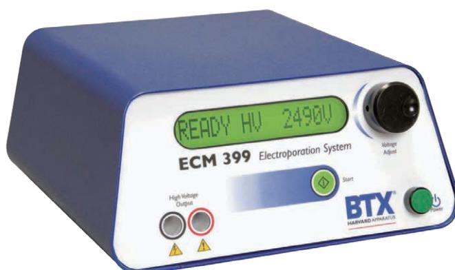
エクスポネンシャル波形は、遺伝子導入分野で広く採用されている波形で、バクテリアなどの遺伝子導入に多用される5msecパルス幅（時定数）の出力や植物・哺乳動物細胞等の遺伝子導入時の低電圧設定にも対応しています。
