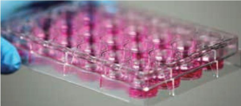
NEST社の細胞培養プレートはコーナーが丸みを帯びており取り扱いやすくなっています。背が低く蒸発を抑えるようデザインされたフタは均一な増殖を保証します。培養表面を組織培養用に処理されたプレートと未処理プレートの両方のご用意があります。未処理プレートの表面は細胞培養用に処理された表面よりも疎水性が高く、細菌培養用のペトリディッシュに近いものになっています。その四隅にある短い脚により顕微鏡レンズに傷がつくことを防いでいます。
