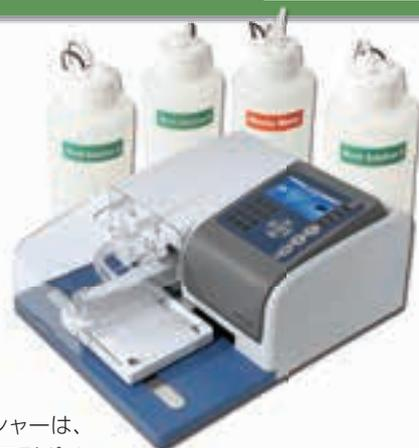
研究には柔軟性が必要ですが、SmartWasher™ 96 はそれを提供します。この全自動ウォッシャーは、U、V、C、または平底のフルプレート、部分プレート、ストリップに対応しています。複数の吸引ポイント設定により、吸引後のウェル内の残留液体を最小限に抑えることができます。分注量、吸引時間、ソーク振とうサイクル、振とう速度など、すべてのパラメータは4.3インチの大型LCDディスプレイとキーパッドで簡単にプログラムできます。最大100の洗浄プロトコルをSmartWasher™ 96に保存し、必要なときに呼び出したり、フラッシュドライブを使って装置間で転送したりすることが可能です。
