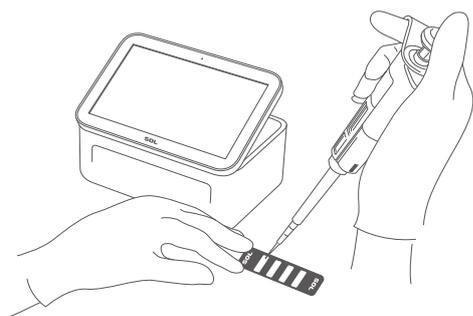
ピペットを用いて細胞懸濁液10 $\mu$ Lをカートリッジに添加
