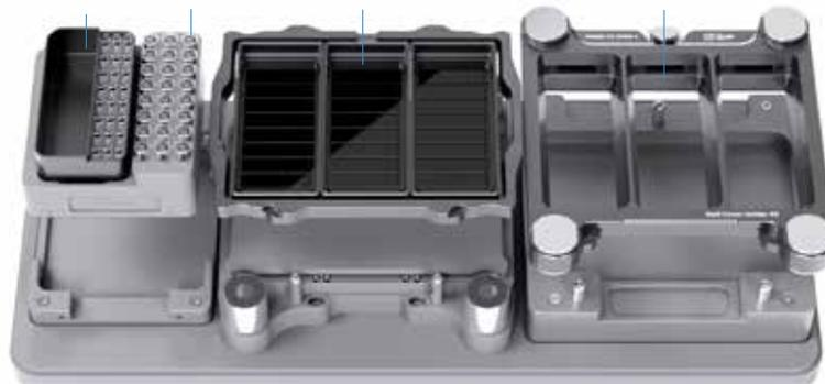
反応液を入れた 8 連チューブとデジタル PCR 専用消耗品を装置の指定された場所にセットします。
