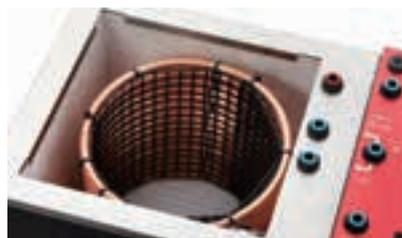
フレークアイスを利用する冷水循環器です。一般的なチラーに比べ早く4℃付近へ冷却を行います。専用設計の冷水循環器でBioruptor®-Oneの超音波発生タイミングとシンクロし超音波 OFFのタイミングで冷水を循環します。水流による超音波破碎効率に影響を与えません。
