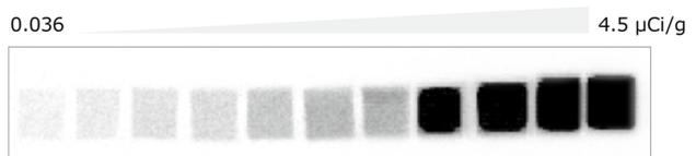
American Radiolabeled Chemicals 社の Carbon-14 スタンダードをストレージフオスファースクリーンで 3 時間露光した後、Sapphire Biomolecular Imager で撮影したもの。
