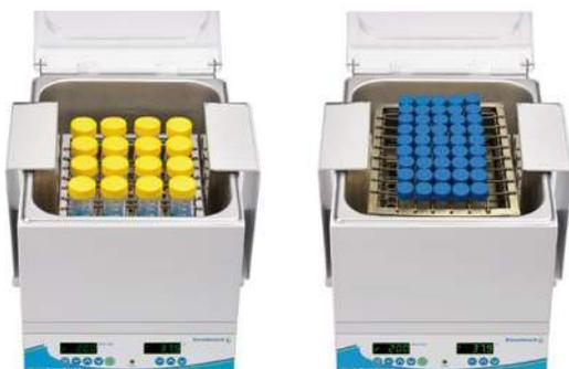
Benchmark Orbi-Shaker™ シリーズで定評あるベルトレスモータードライブシステムを採用し、最大 80℃までの正確な温度制御を追加したコンパクトなウォーターバスです。継ぎ目のないステンレス製のチャンバーは 12 リットルの容量があります。15ml と 50ml の遠心管、三角フラスコ、1 リットルまでの培地ボトルを固定するためのユニバーサルスプリングブラットホームが付属しています。また、ヒンジ式で取り外し可能な蓋が付属しており、エネルギーの無駄を省き、水しぶきを防ぎ、試料から結露を遠ざけることができます。
