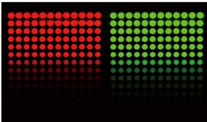
Full Moon BioSystems Scanner Calibration Slide を Sapphire Biomolecular Imager の 520nm と 658nm のチャンネルを使用し、10 $\mu$ m の解像度でスキャンした。
