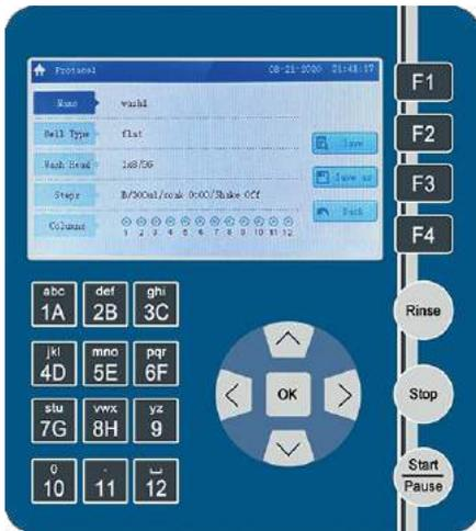
研究には柔軟性が必要ですが、SmartWasher™ 96 はそれを提供します。この全自動ウォッシャーは、U、V、C、または平底のフルプレート、部分プレート、ストリップに対応しています。複数の吸引ポイント設定により、吸引後のウェル内の残留液体を最小限に抑えることができます。分注量、吸引時間、ソーク・振とうサイクル、振とう速度など、すべてのパラメータは4.3インチの大型LCDディスプレイとキーパッドで簡単にプログラムできます。最大100の洗浄プロトコルをSmartWasher™ 96に保存し、必要なときに呼び出したり、フラッシュドライブを使って装置間で転送したりすることが可能です。
