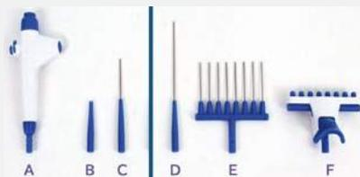
ASPIRE™ はメンテナンスフリーなポンプ内蔵型アスピレーターでコンパクトながら、十分な安定性があります。吸引圧力は調節も可能です。圧力計は見やすい位置に表示され、常時モニタリングできます。
